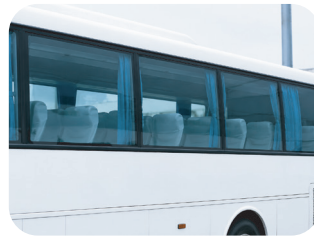
شیشه های جانبی اتوبوس Rear Glass شیشه لمینت خم مطابق الزامات ایمنی خودرو
